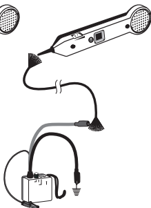
Figure 2b. Rastreamento de cabos
